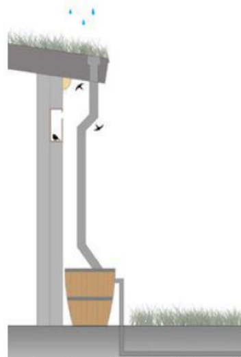
opslaan en dan pas afvoeren van hemelwater / details voor de huisvesting van vogels en vleeruizen
